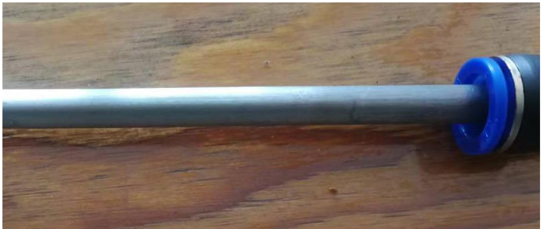
图 7 电解后的钛管
