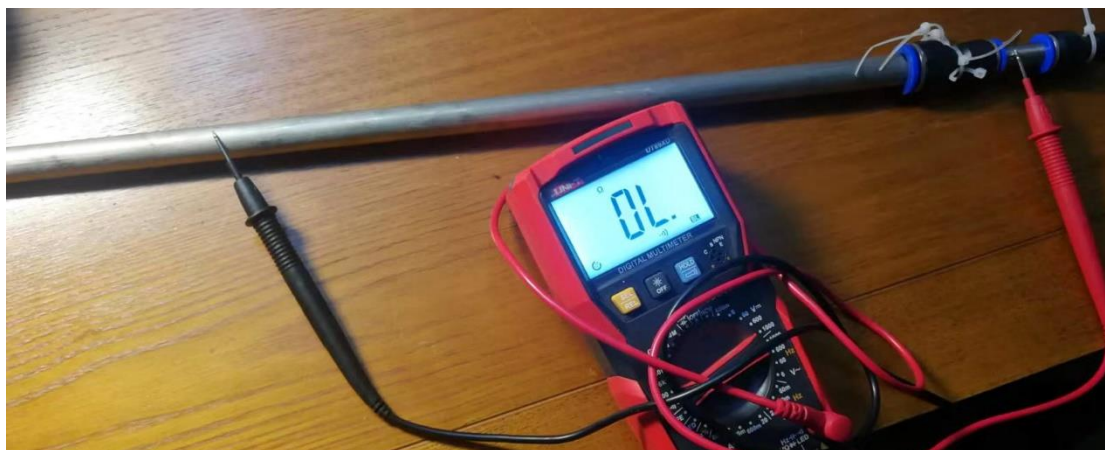
图 8 组装后的反应器内外管绝缘良好
