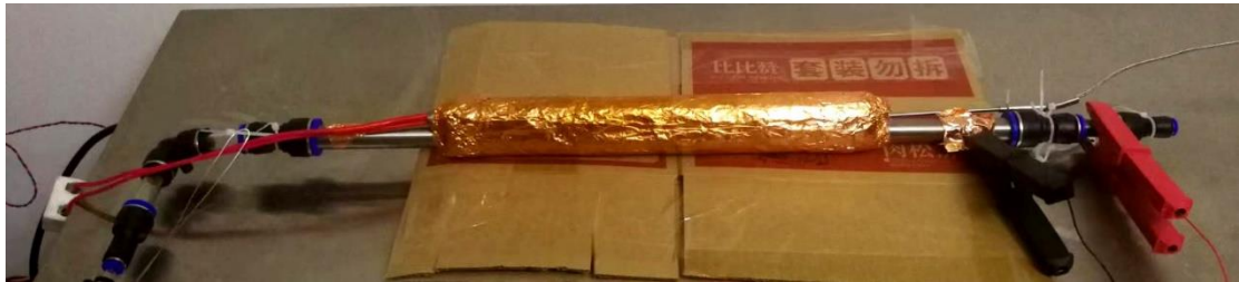
图 2.安装了加热器和热电偶的钛管反应器
