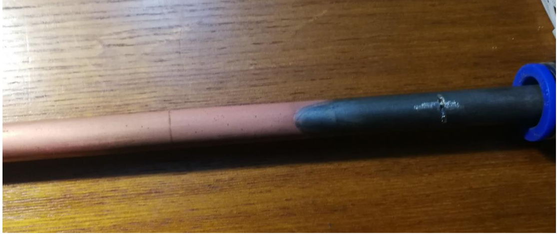
图 6 电镀铜后的钛管
