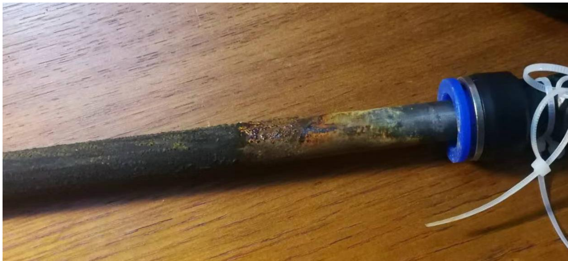
图 4 电镀铁后的钛管
